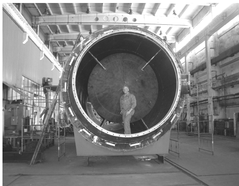
DN 2900 lyddæmper til kraftværk på Kreta. Lyddæmperen er 12 meter lang og vejer 25.000 kg
